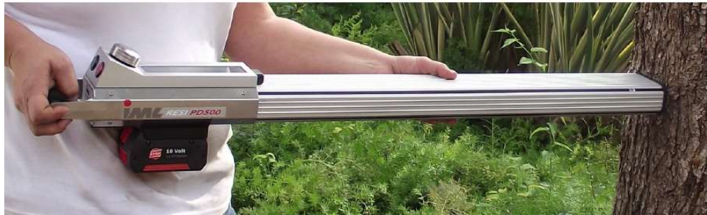
Figura 2 – Quantificação de afetações internas com recurso a resistógrafo IML PD-500.
